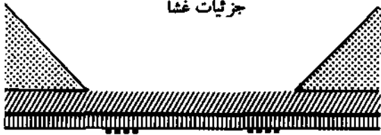
شکل ۱۰ - نمودار اجمالی FPW. در نمای عمودی، غشا به رنگ سیاه نشان داده شده است و IDTها در دو سوی آن واقع شده‌اند [۷].
