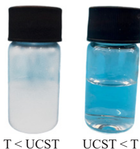
شکل ۶- محلول ۰/۱٪ وزنی کوپلیمر AAm_{75}-co-AN_{25} در آب یون زدوده.
