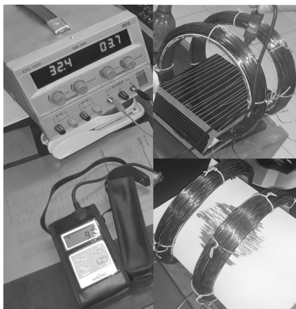
شکل ۱- تصویری از (a) شدت میدان مغناطیسی اندازه‌گیری شده (b) کاوند اندازه‌گیری میدان مغناطیسی در دستگاه و (c) آزمون میدان با براده‌های آهن.
