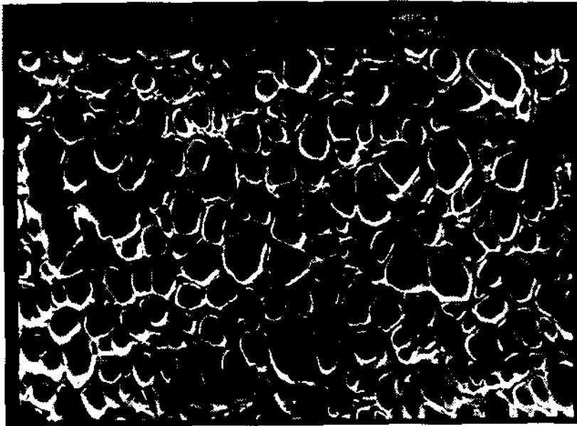
شکل ۸- تصویر SEM فیلم پلی‌پیرول تهیه شده به روش گالوانوپایی (در چگالی جریان 0.75\text{ mA/cm}^2 به مدت ۴ دقیقه) از محلولی شامل پیرول ( 0.06\text{ M} ) و الکترولیت حامل ( 0.08\text{ M KNO}_3 ).
