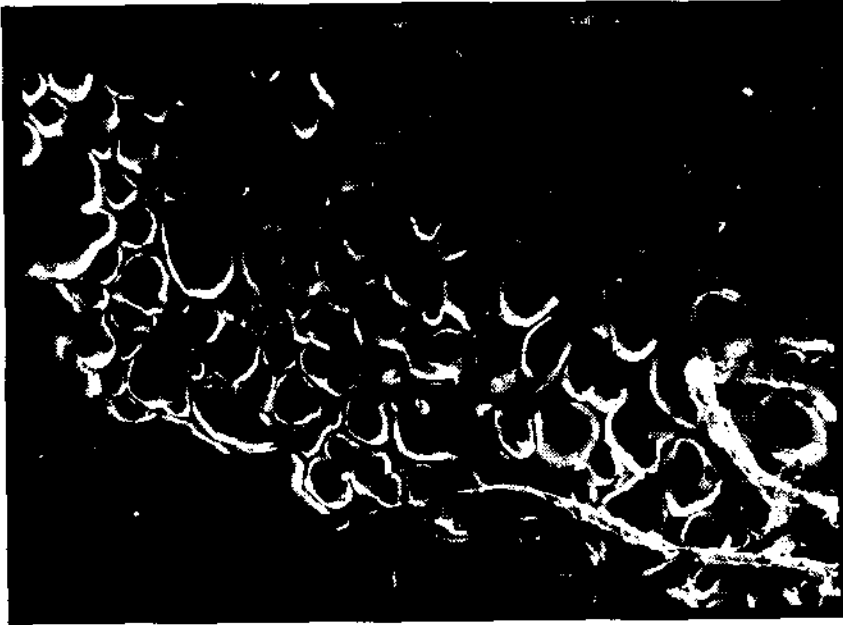
شکل ۷- تصویر SEM فیلم پلی‌پیرول تهیه شده به روش پتانسیل پایی (پتانسیل اعمال شده 0.75\text{ V} نسبت به الکترود مرجع به مدت ۴ دقیقه) از محلولی شامل پیرول ( 0.06\text{ M} ) و الکترولیت حامل ( 0.08\text{ M KNO}_3 ).
