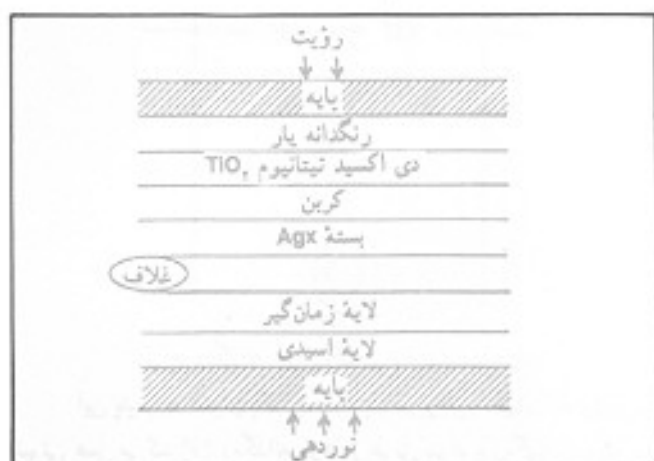
شکل ۳ - شمایی از فیلم رنگی فوری کدک، PR-10
